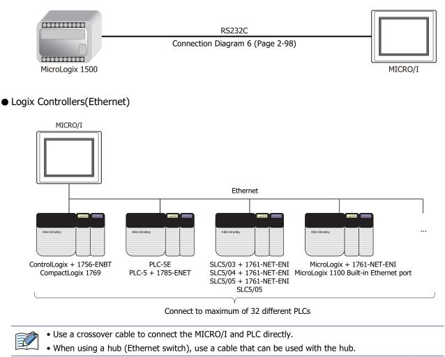
• Control Logix, CompactLogix, FlexLogix (CPU Unit)
